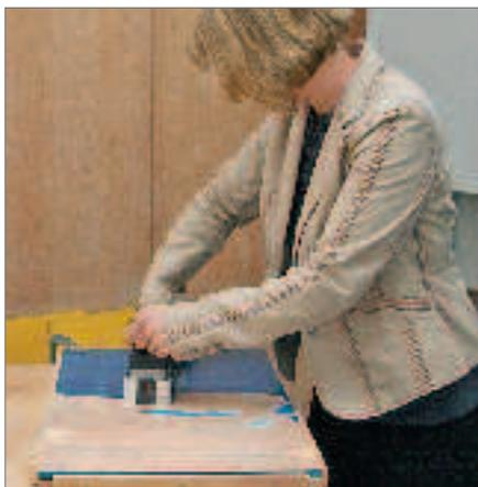
Damit das Ergebnis stimmt, muss die alte Oberfläche Bahn für Bahn mit leichtem Druck abgefräst werden.
