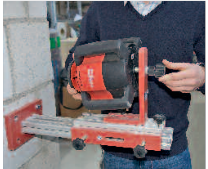
Den Rotationslaser auf den Fassadenadapter mit dem Gewinde aufschrauben. Die Bedienoberfläche zeigt in Richtung Zenith.
