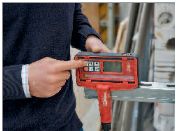
Klicken Sie doppelt auf die Auto-Alignment-Funktion am Empfänger. Der Laser bewegt seinen Kopf zum Nullpunkt des Empfängers.
