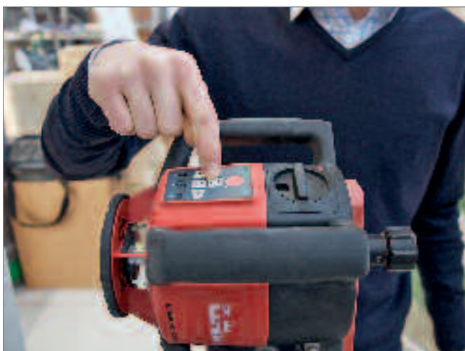
Drücken Sie den gekennzeichneten Rotationsknopf am Laserempfänger bzw. Rotationslaser und bringen Sie den Laser dadurch zum Rotieren.
