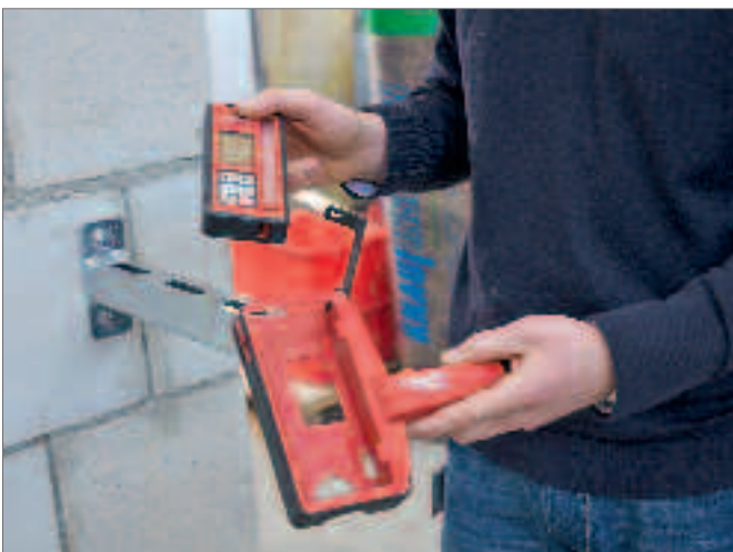
Danach setzen Sie den Empfänger in die Laserempfängerhalterung PRA 80 ein...
