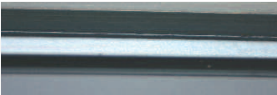
Foto 2: Bei dieser Aufnahme tritt sichtbar Butyl über die ganze Länge des Abstandhalters aus.
